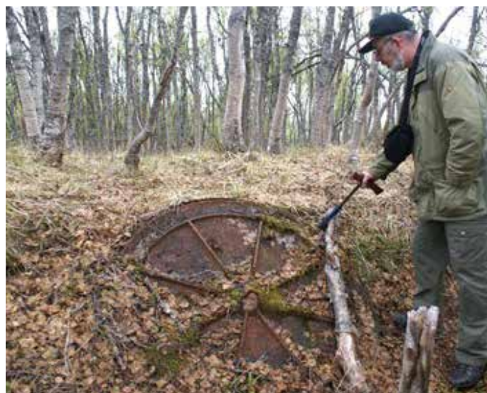
Bremsebanehus og bremsebanehjul i kulturminnemiljøet i Øvre Kleiva. Bremsebanen fungerte slik at lastede vogner på vei ned fra gruva dro tomme vogner opp igjen. Hastigheten ble styrt fra bremsehuset. På bildene ses informant Oddbjørn Martinussen til venstre og geolog Peter Brugman til høyre. Foto: Lars Slettjord/Skatter i fjell 2011.
