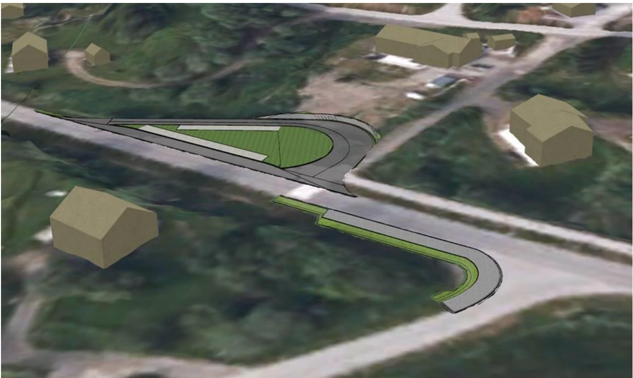
Figur 5-6. Sundveien i forgrunnen, nytt fortau og planlagt bussholdeplass langs fv. 7552.
